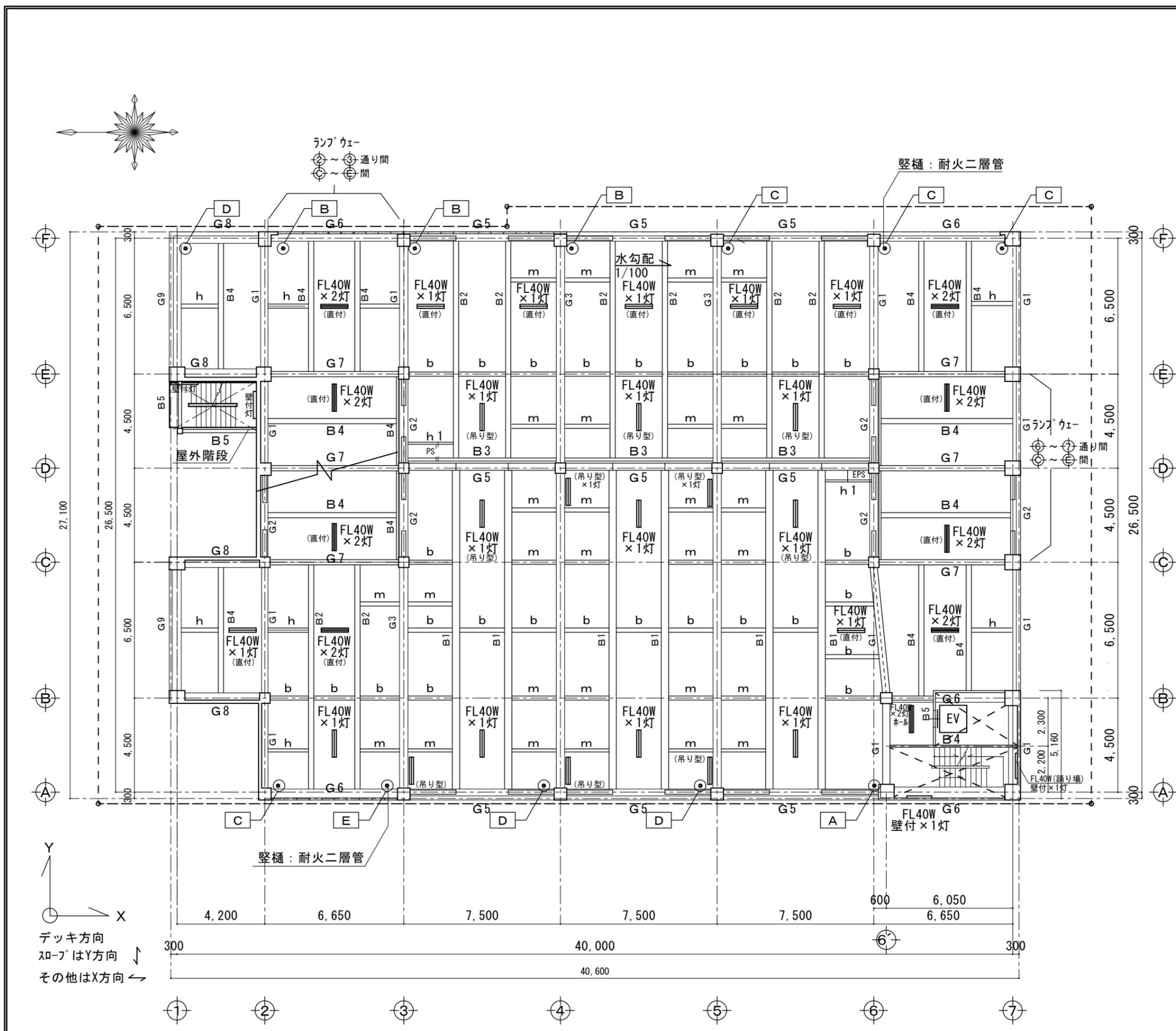
2階(3階床)梁伏図 S=1/200 (梁：見上げ図)
